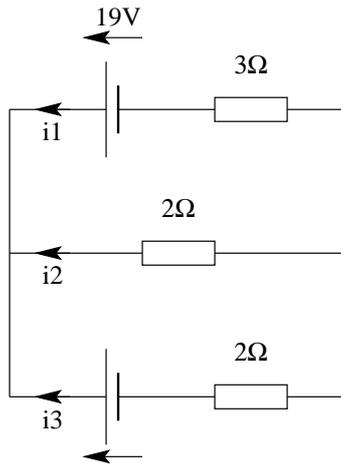
Calculer les courants dans les branches du circuit ci-dessus. On rappelle les lois de Kirchhoff : la somme (algébrique) des courants entrant en un noeud est nulle, et la somme des tensions (algébriques) le long d'une boucle du circuit est nulle. On a aussi la loi d'Ohm :
